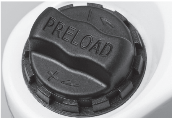
Abbildung 53: Einstellrad SAG auf der Krone der Federgabel
